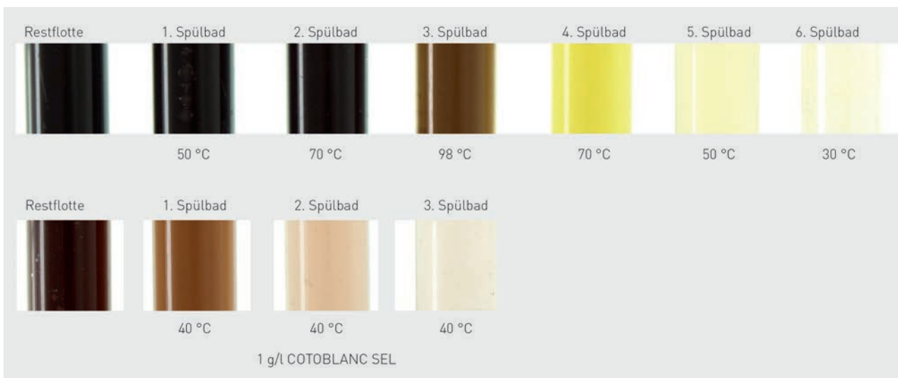
Abb. 2: Vergleich der Spülbäder im Reaktivfärbeprozess (oben: Commodities / unten: 40 °C Prozess mit Einsatz von BEZAKTIV GO und COTOBLANC SEL).
