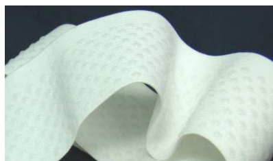
Punktbeschichtung mit ALPATEC 745
